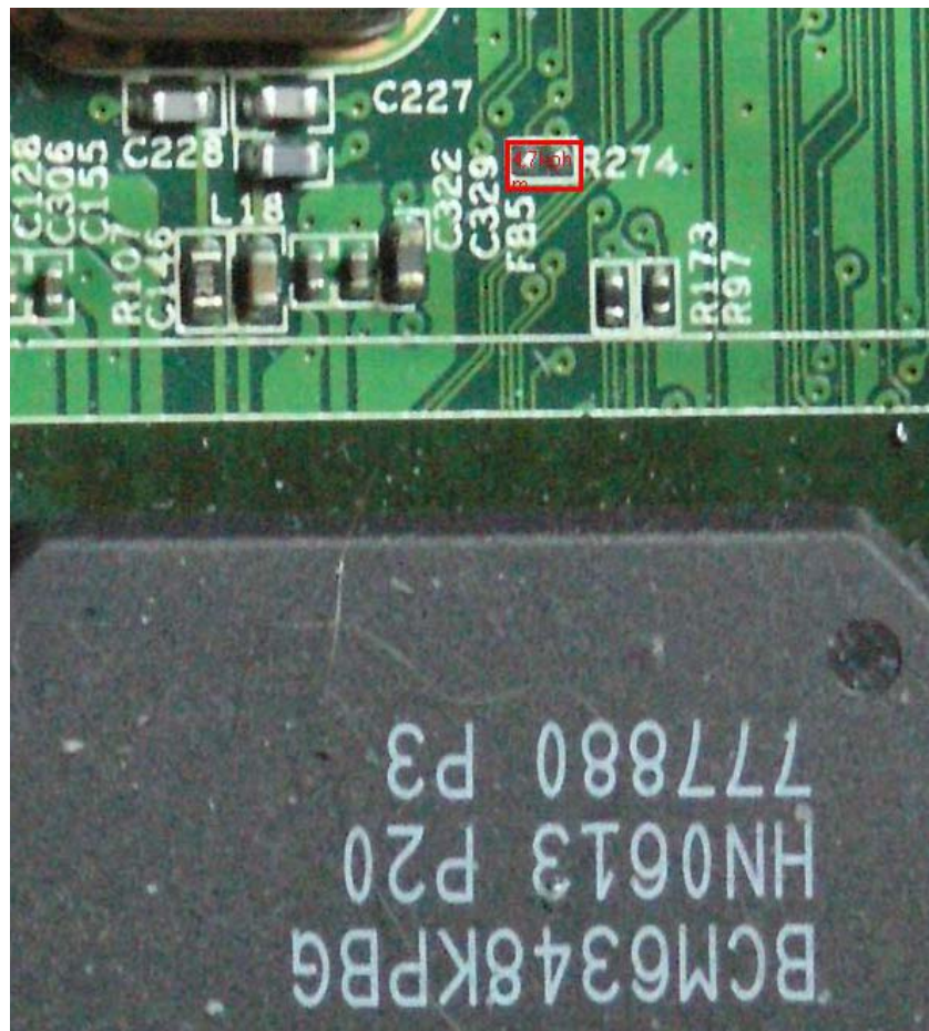
Figura 2 – R274 da inserire per attivazione interfaccia USB HOST
